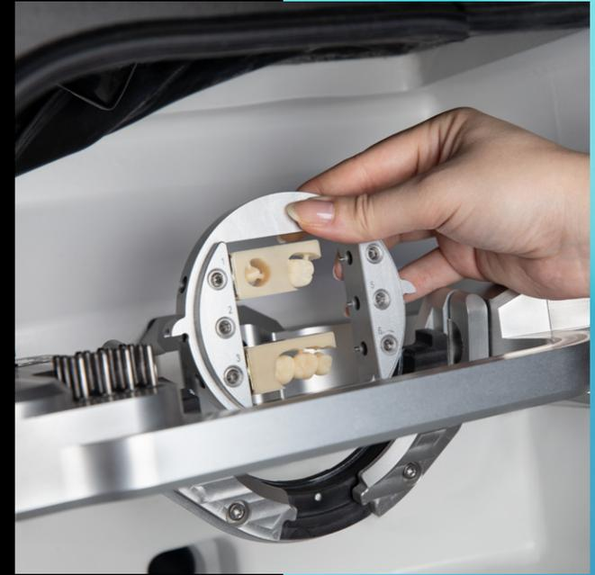
Mit der E5 können Sie nicht nur Ronden bearbeiten. Mit dem entsprechenden Halter fertigen Sie mühelos auch bis zu 6 Blöcke unterschiedlicher Größe.
